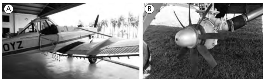
FIG. 5.15 (A) Avião agrícola com barra do pulverizador montada sob a asa e (B) e detalhe mostrando a hélice que aciona a bomba centrífuga localizada sob a fuselagem da aeronave, movida por energia eólica gerada pelo movimento da aeronave
