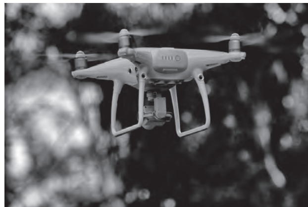
FIG. 4.5 Veículo aéreo não tripulado (VANT) com câmera digital de alta resolução Fonte: https://pxhere.com/en/photo/1379974 .
